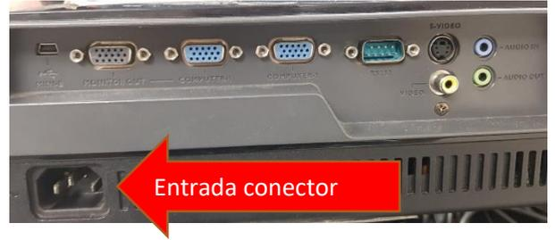
**Paso 2:** conectar el cable VGA al proyector y el HDMI a la netbook corroborando el acoplamiento cuidadosamente y el de la unión con el adaptador. *El conector VGA puede ir en cualquiera de los puertos azules.*
